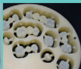
Disco di PMMA colorato fresato
